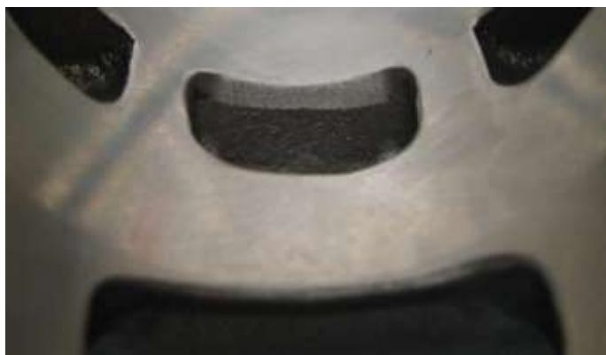
La brida de sellado para la toma de escape puede mostrar ya sea acabado de la superficie de fundición o signos de mecanizado del fabricante.
