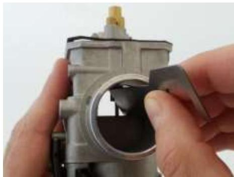
d) La posición de la tapa del carburador debe ser fijada por medio de la placa de fijación (pos. 1 ver ilustración de abajo, ROTAX parte no. 251 790, ver imagen adjunta).
