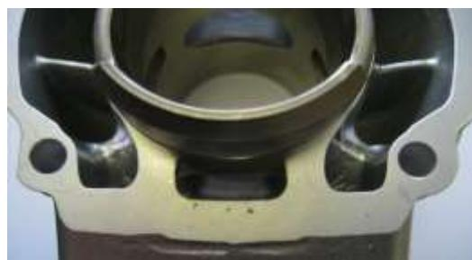
El borde superior del puerto de escape puede mostrar algo de mecanizado preexistente del fabricante. La brida de sellado para la toma de escape puede mostrar signos de mecanizado del fabricante.
