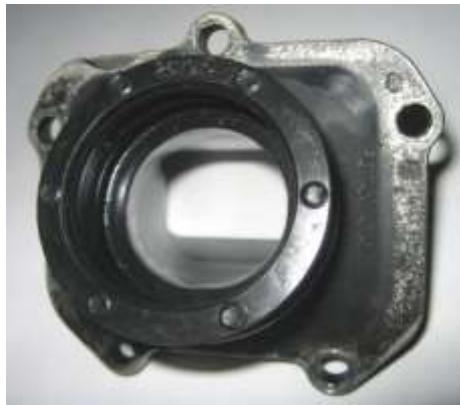
c) Algunas rebabas de remoción de fábrica pueden estar presente en la unión del contorno interior y la cara de montaje del carburador. Se trata de una operación de recorte manual que consiste en un pequeño recorte de la esquina de menos de 3 mm de ancho. No se permite ningún maquinado o esmerilado adicional.
