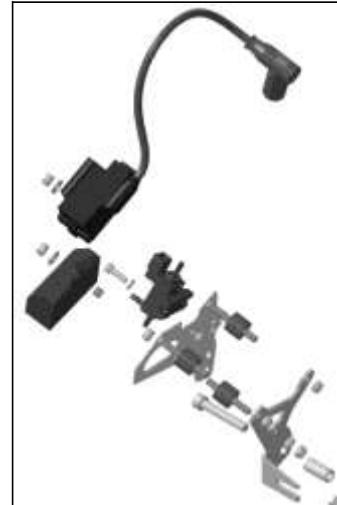
En las versiones de montaje de acuerdo a las Ilustraciones de la izquierda, la válvula magnética debe ser instalada por medio de un tope de goma en el soporte (válido sólo para SENIOR MAX y DD2)
