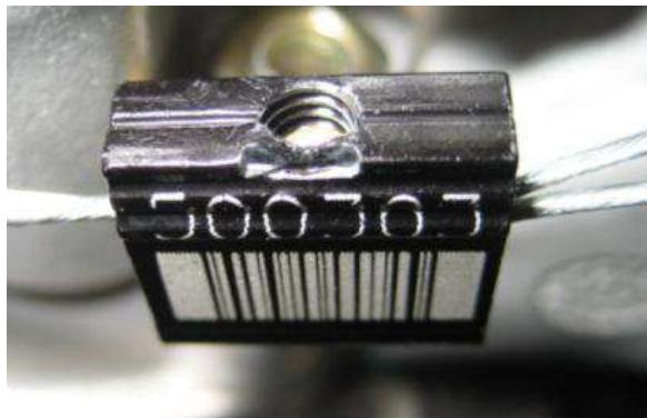
Después de cerrar el cable de precintado del motor debe ser apretado utilizando una pinza, parte ROTAX no. 276 110 (ver foto).
