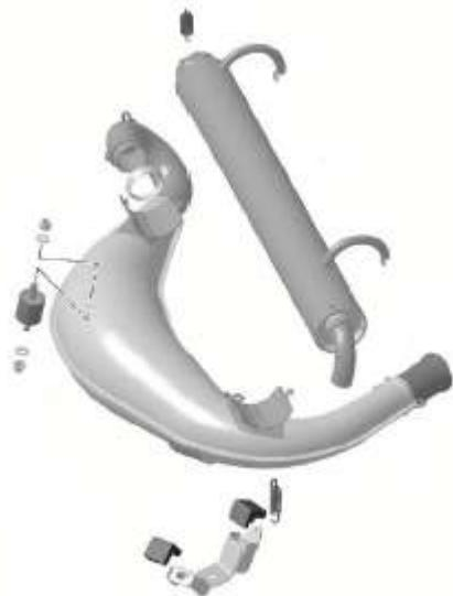
Todas las versiones deben ser tal como las suministra ROTAX y no pueden ser modificadas excepto por el reemplazo del material absorbente del silenciador y el uso de sujetadores roscados en lugar de los remaches para asegurar la tapa del silenciador.
