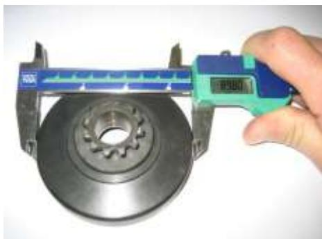
El Diámetro de la campana de embrague debe ser medido con un calibre en el extremo del lado cerrado de la campana (no en el extremo abierto de la campana de embrague).
