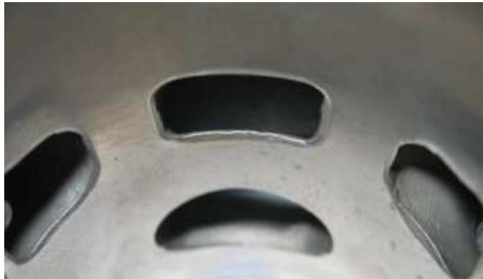
En los cilindros marcados 223 993, 223 994 y 613 933 el borde superior del puerto de impulso central puede mostrar el mecanizado de fábrica.
