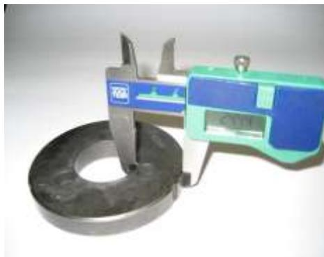
La medición se tiene que hacer en los 3 extremos abiertos de las zapatas del embrague, 5 - 10 mm de la ranura maquinada (todos las zapatas del embrague deben estar completamente cerradas en la medición - sin espacio).
