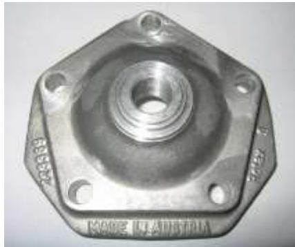
c) La altura del inserto de cámara de combustión tiene que ser 27,55 mm con una tolerancia De +0,0 / -0,1 mm (A) y 28,80 mm con una tolerancia de + / - 0,2 mm (B) .
