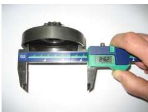
El diámetro interior tiene que ser medido con un calibre. La medición se tiene que hacer en el centro del tambor del embrague (en el área de contacto del tambor de embrague).
