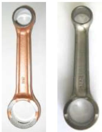
c) El brazo de la biela no está maquinado (cobre plateado) . No se permite el pulido del brazo de la biela.
