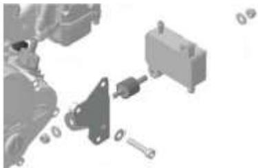
La bomba de combustible debe ser montada en el soporte 651 055, fijada a la cubierta, como en la figura. Montar la bomba de combustible al chasis con los dos silenblocks es una opción permitida, en este caso la bomba debe ser montada por debajo de la línea central de entrada al carburador.
