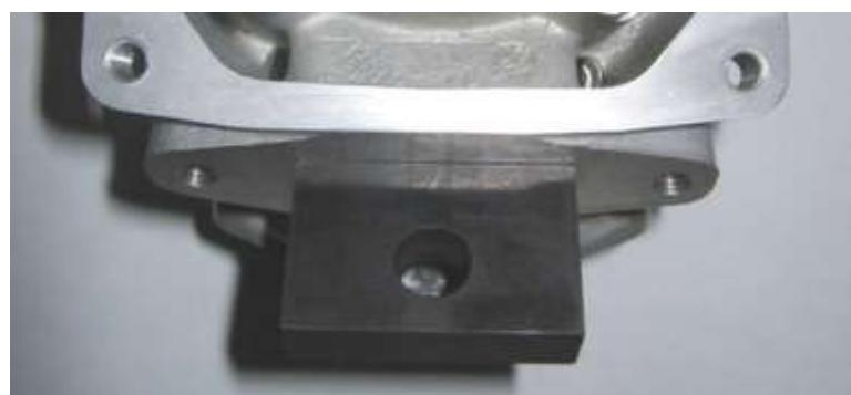
k) La modificación de la junta de la válvula de escape (ROTAX parte no. 250 231) es ilegal.
