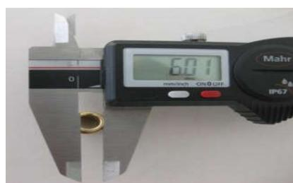
Atomizador, diámetro de perforación transversal: 4,05 + / - 0,15 mm
