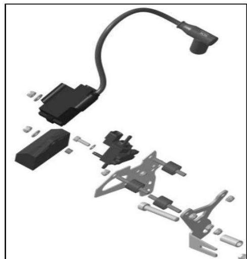
En las versiones que se muestran en las ilustraciones de la derecha, el cable de tierra de la instalación eléctrica debe estar conectado al tope de goma inferior del soporte.
