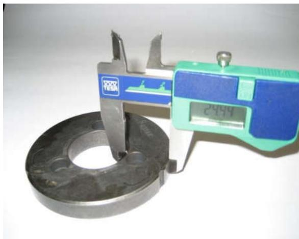
La medición se tiene que hacer en los 3 extremos abiertos de las zapatas del embrague, 5 - 10 mm de la ranura maquinada (todos las zapatas del embrague deben estar completamente cerradas en la medición - sin espacio).
