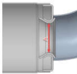
c) La medida interna del cuerpo de escape del extremo de salida de gases representada en la figura siguiente con la letra (a). Debe tener un máximo de 63mm
