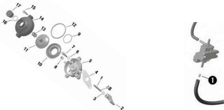
a) En la versión 2, instalar una válvula de impulso original **1** en la manguera de presión es ahora un ajuste permitido
