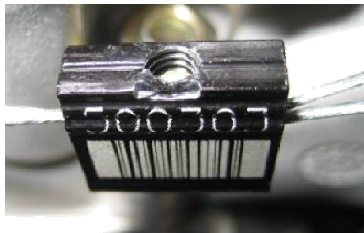
Después de cerrar el cable de sellado del motor debe ser apretado utilizando una pinza, parte ROTAX no. 276 110 (ver foto).
