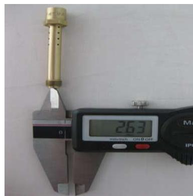
4x4 agujeros transversales diámetro: Calibre especial de 0,90 mm no puede entrar en ninguno de los 16 agujeros transversales (utilización de calibre jet set Parte ROTAX. 281 920).
