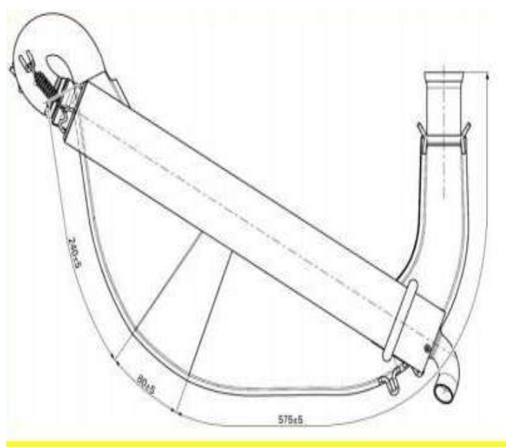
27.2 Todas las versiones deben ser tal como las suministra ROTAX y no pueden ser modificadas excepto por el reemplazo de la lana de escape del silenciador y el uso de tornillos roscados en lugar de los remaches para asegurar la tapa del silenciador.
