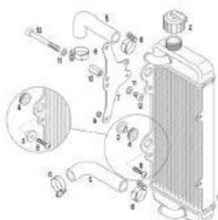
Área de enfriamiento= Altura: 290mm Ancho: 133mm Espesor=32mm
