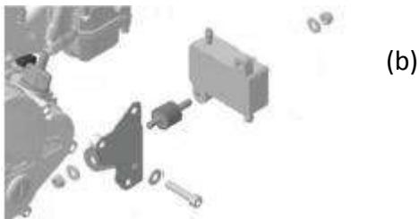
La bomba de combustible debe ser montada en el soporte 651 055, fijada a la cubierta, como en la figura. Montar la bomba de combustible al chasis con los dos silenciosos es una opción permitida, en este caso la bomba debe ser montada por debajo de la línea central de entrada al carburador.
