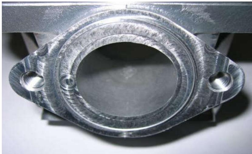
La brida de sellado para la toma de escape puede mostrar ya sea acabado de la superficie de fundición o signos de mecanizado del fabricante.
