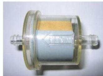
No hay piezas adicionales en la línea de combustible, excepto la bomba de combustible, así como el filtro de combustible obligatorio para ser montado entre el tanque de combustible y la bomba de nafta.
