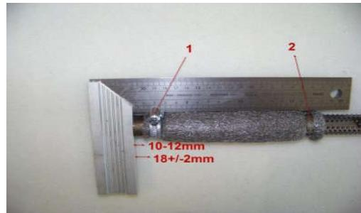
Abrazadera (1) debe fijarse a una distancia de 18 + /-2mm, medida desde el extremo del tubo.
