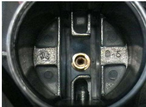
Diámetro angular: Sonda de prueba 0,55 puede no encajar (uso calibre jet set Parte ROTAX 281 920.).
