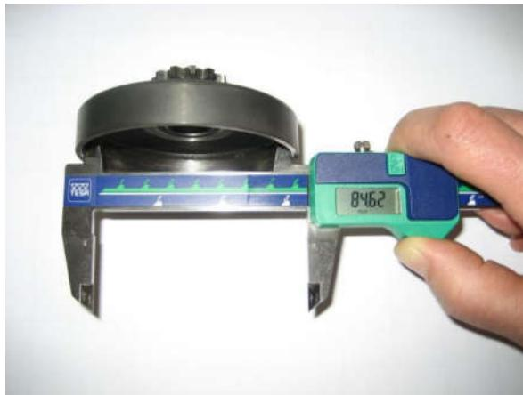
El diámetro interior tiene que ser medido en el centro del tambor del embrague (en el área de contacto del patín de embrague).
