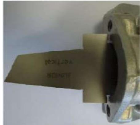
m) **Válvula de Escape (125 MAX y 125 MAX DD2):** distancia entre la brida de válvula de escape, (del cilindro al pistón)
