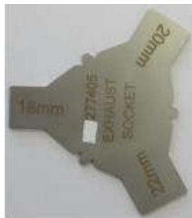
El perfil interno de los conos de la brida de escape debe verificarse con la plantilla Rotax 277405. Montar la plantilla micro “18mm”mini “22mm”lo más posible en la brida de escape (sin junta y eliminando los depósitos de carbón) tiene que haber una luz uniforme y constante entre la plantilla y el cono de la brida
