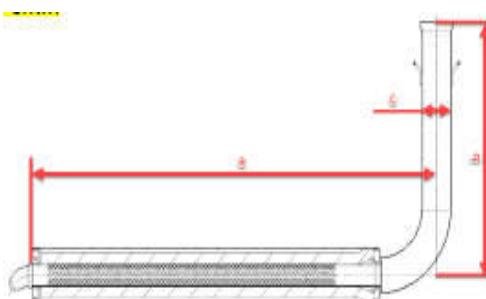
b) Una bola de acero con un diámetro de 28mm no debe poder pasar por la sección (A) y una bola de 26mm debe poder pasar a través de la sección (A)
