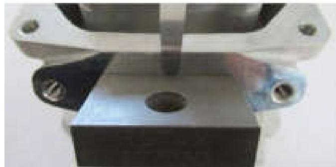
Coloque el pistón en PMI inserte la plantilla rotax parte no. 277030 hasta que se detenga en la superficie del cilindro. Gire el cigüeñal hasta que el pistón llegue al PMS sin que el pistón toque en la plantilla. En el área de contacto circular entre la válvula de escape y la brida del cilindro una sonda de 0'25mm de espesor no podrá ser insertada
