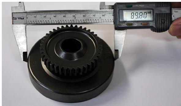
El Diámetro exterior de la campana de embrague debe ser medido con un calibre en el extremo del lado cerrado de la campana (no en el extremo abierto de la campana de embrague).
