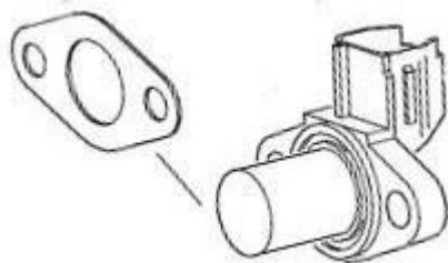
**SUGERENCIA:** En caso de duda una revisión fácil es colocar una bola de acero (3-5 mm de diámetro) en la pastilla (lado del motor), la bola de acero debe permanecer en el centro de la superficie de captación.
