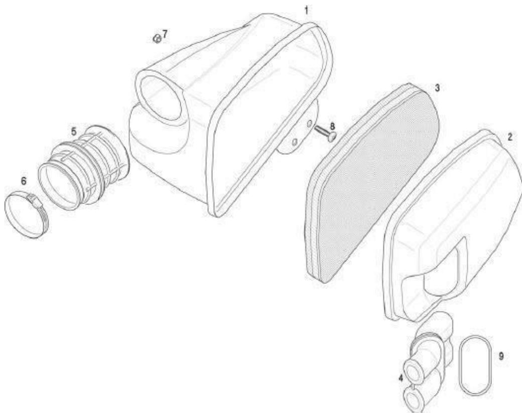
Tubo Silenciador de admisión (posición 1), así como la toma del carburador (pos. 5) sólo son legales si está marcado con " ROTAX".
