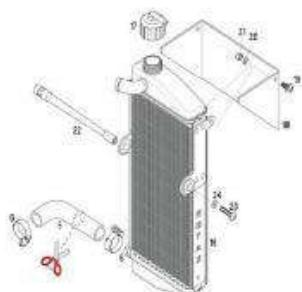
Área de enfriamiento= Altura: 290mm, Ancho: 138mm Espesor=34mm.
