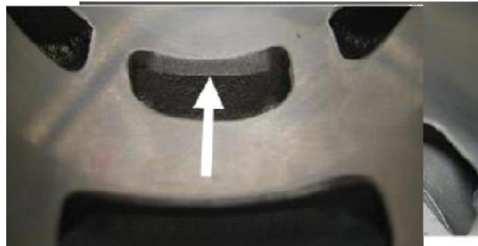
En los cilindros marcados 223 993, 223 994 y 613 933 el borde superior del puerto de impulso central puede mostrar el mecanizado de fábrica.
