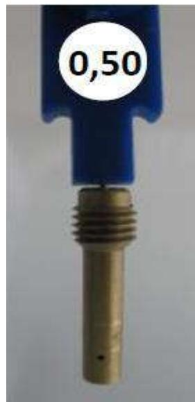
f) Retire el atomizador del cuerpo del carburador por medio del conjunto de herramienta Venturi (ROTAX no 676034) atomizador, longitud total: 23.75 +/- 0,35mm
