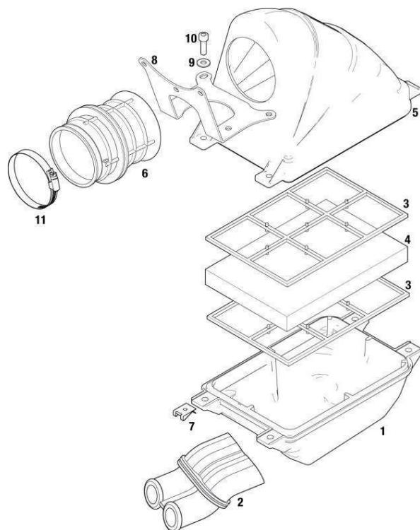
b) La parte inferior de la caja Silenciador de admisión está marcada en el interior con la Parte ROTAX. 225 015.
