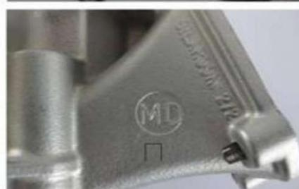
h) **125 Junior MAX y 125 MAX**: altura del cilindro debe ser 87 mm -0,05 / +0,1 mm (medido con un calibre digital. 200 mm de longitud).
